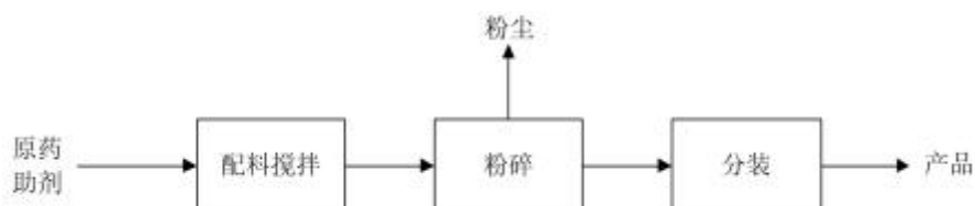
图 4.1-8 可溶性粉剂生产线生产工艺流程及产污环节图
