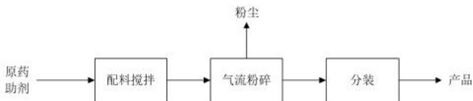
图 4.1-4 可湿性粉剂生产线生产工艺流程及产污环节图
