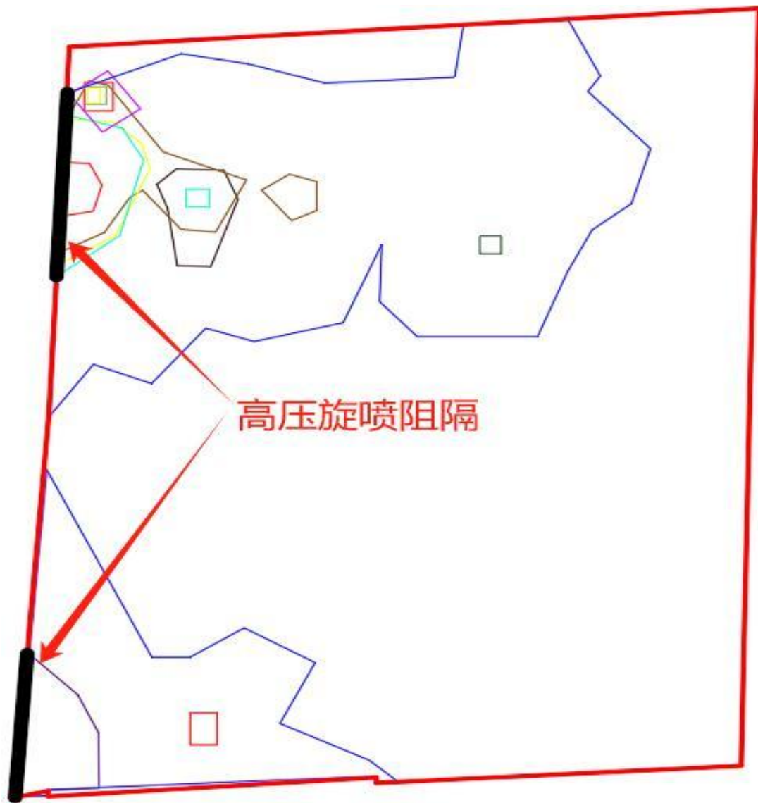
图5.2.5-1 高压旋喷阻隔施工范围
