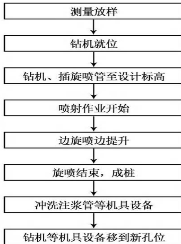
图5.2.5-2 高压旋喷施工工艺流程
