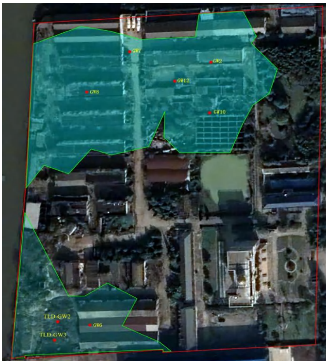
图5.2.3-2 地下水超标严重点位区域
